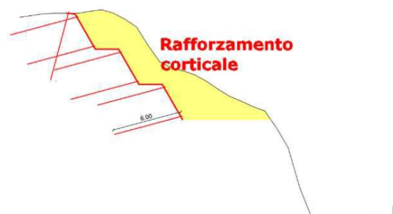
Figura 2 - Esempio di rafforzamento corticale con rete e chiodi autopercuotenti
