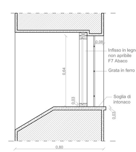
SD14\_ SEZIONE DETTAGLIO INFISSO PIANO -1\_SCALA 1: 10
